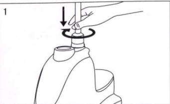
1. Поверните трубку 4 в корпусе отпаривателя в соответствии с направлением стрелки.
